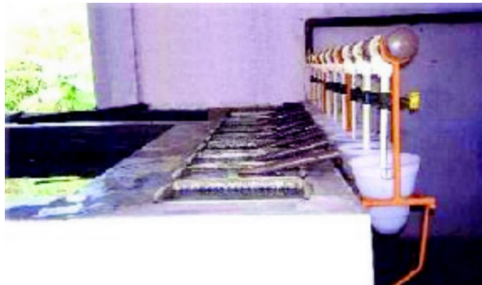
Figura 7. Incubadora comercial para Oreochromis sp. con recirculación de agua.
