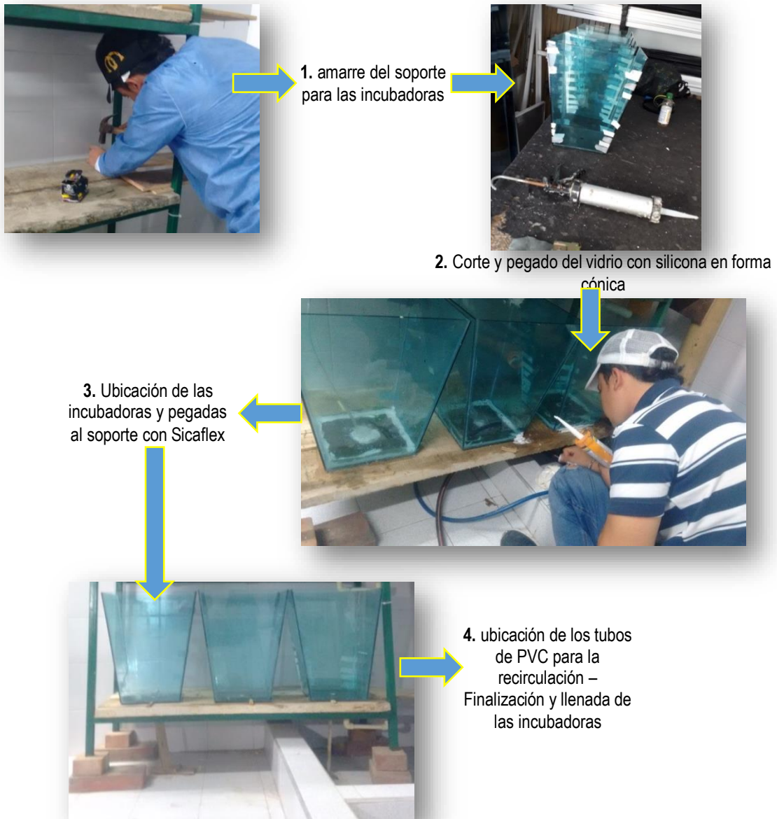
Figura 13. Elaboración del prototipo vidrio.
