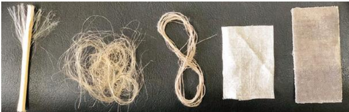
Figura 22 Productos desde la fibra hasta el composite.
