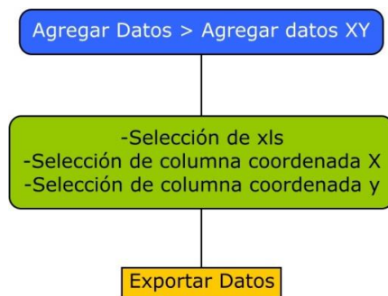
Ilustración 25 Proceso de crear información vectorial tipo punto a partir de una tabla en excel
