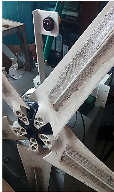
(b). Aspas con refuerzo de Fibra de vidrio y aluminio
