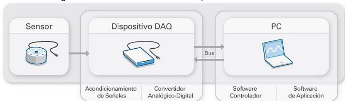
Figura 23. Partes del sistema de adquisición de datos DAQ.
