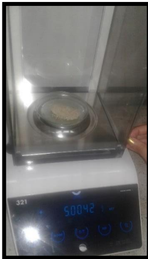
Figura 20. Balanza Analítica – Pesaje de 5 g de Jatropha curcas
