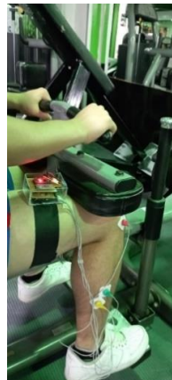
Figura 45 Ejercicio para la toma de la contracción voluntaria máxima isométrica (MVC) en el sóleo.
