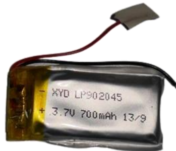
Figura 16 Baterías lipo de 3.7 V
