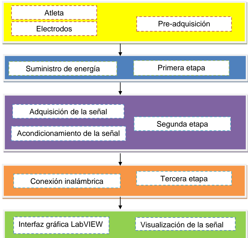
Figura 15 sistema para la adquisición de la señal
