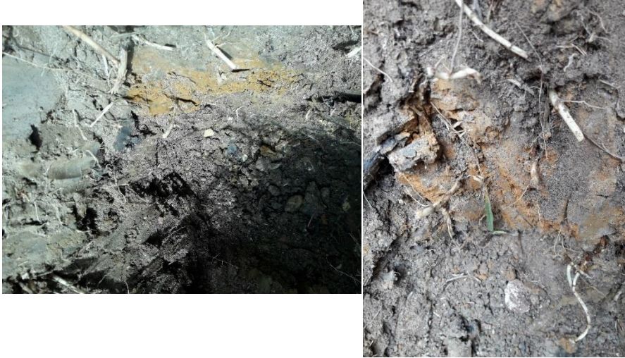
Figura 23. Presencia de Moteados en el Primer Perfil del Punto de Muestreo Numero 1. Fuente: Propia.
