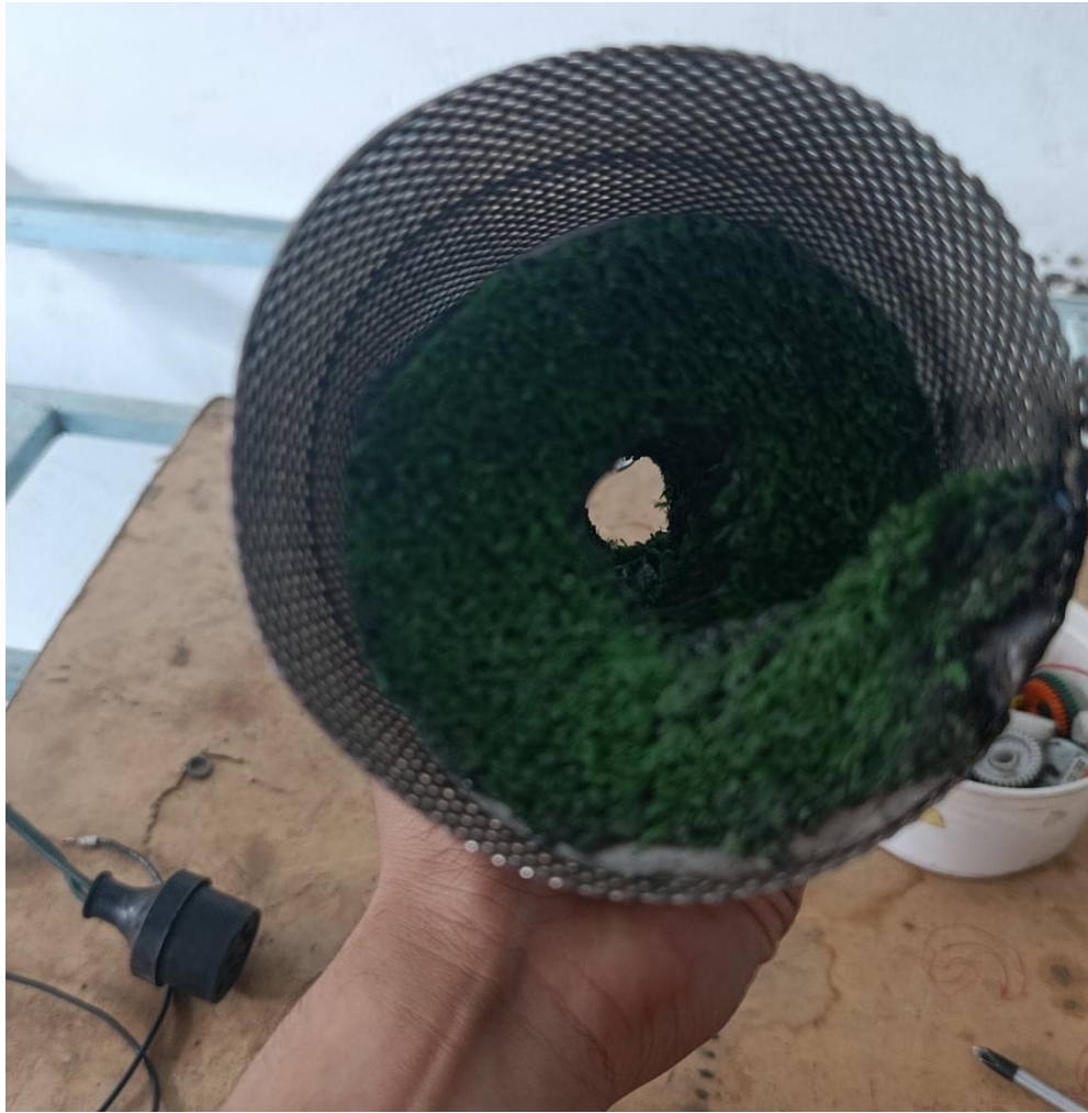
Ilustración 27 Construcción del Sinfín de Lavado
