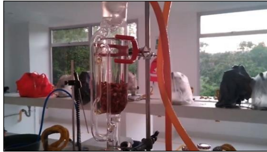
Figura 8. obtención de extracto de Neem por Soxhlet
