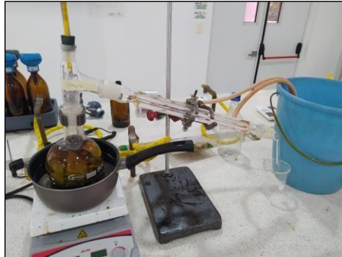
Figura 6. Extracción de aceite hidrolato de pomarrosino
