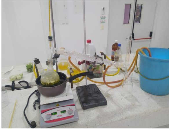
Figura 9. Extracción de aceite esencial de limón
