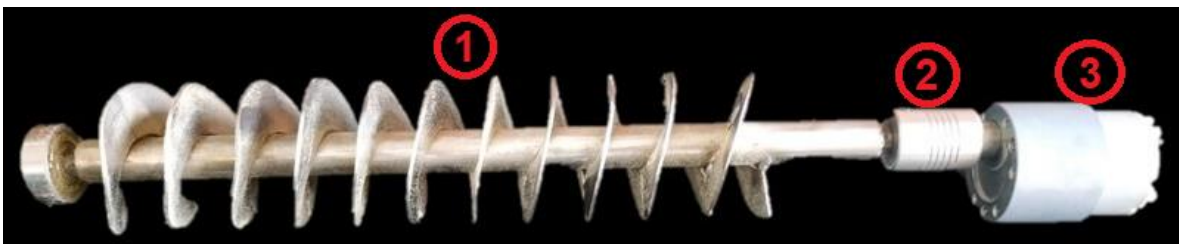
Figura 13. Mecanismo control y suministro alimento. Elaboración propia.
