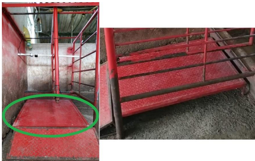
Figura 31. Dispositivo físico báscula. Elaboración propia.
