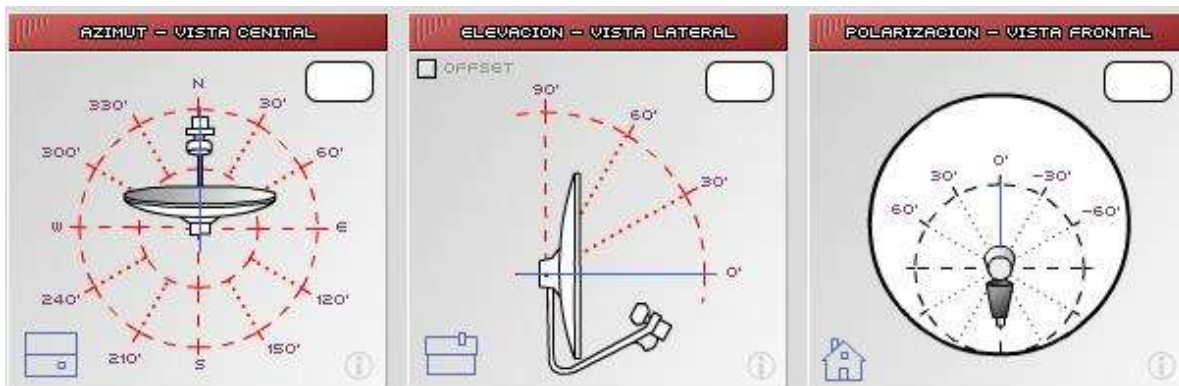
Fig 16 Azimut, Elevación y Polarización de una Antena.
