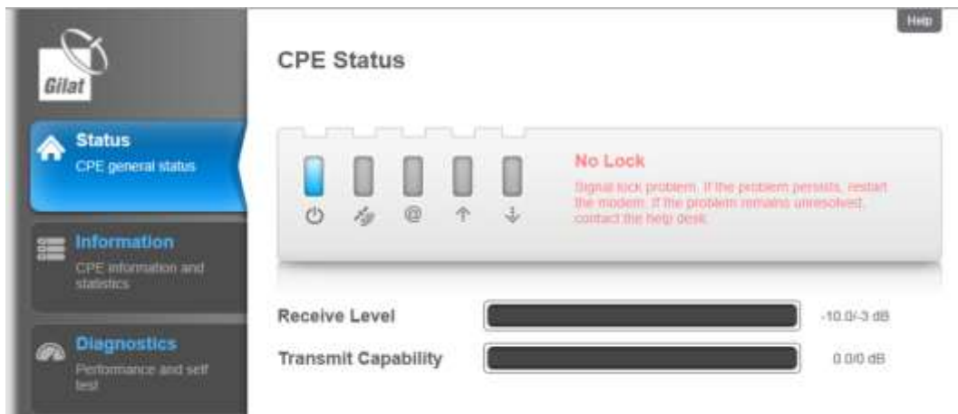
Fig 21 CPE Status Antena Desapuntada.
