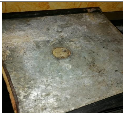
figura 3 Tapa de nevera con presencia de humedad
