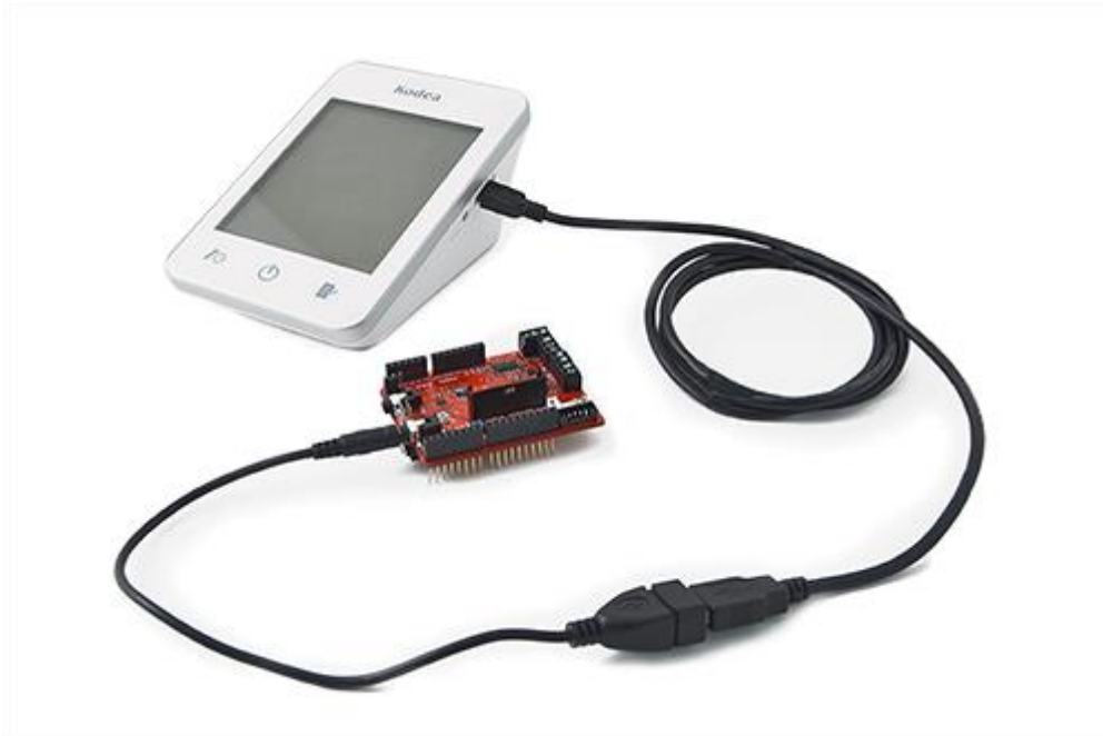
Figura 9. Conexión tensiómetro con e-health sensor. Fuente: Cooking-hacks, 2016 Plataforma electrónica Arduino y Transmisión de datos
