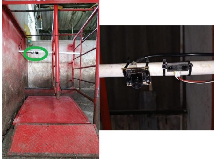
Figura 30. Dispositivos físicos sensor de altura y cámara USB. Elaboración propia.
