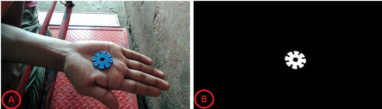
Figura 32. A. Imagen capturada sistema implementado con escena adecuada. B. Segmentación correcta. Elaboración propia.
