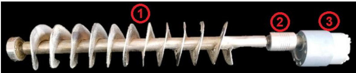
Figura 13. Mecanismo control y suministro alimento. Elaboración propia.
