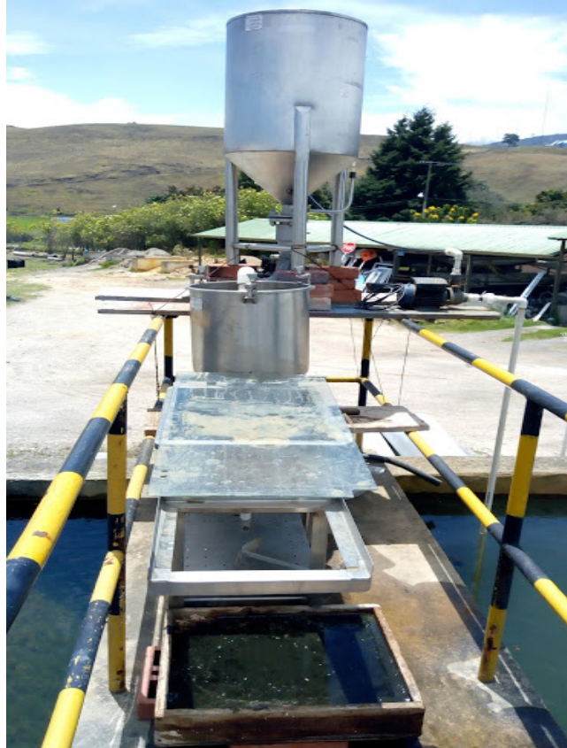
Figura 12. Planta piloto para el muestreo de lodos del sedimentador primario
