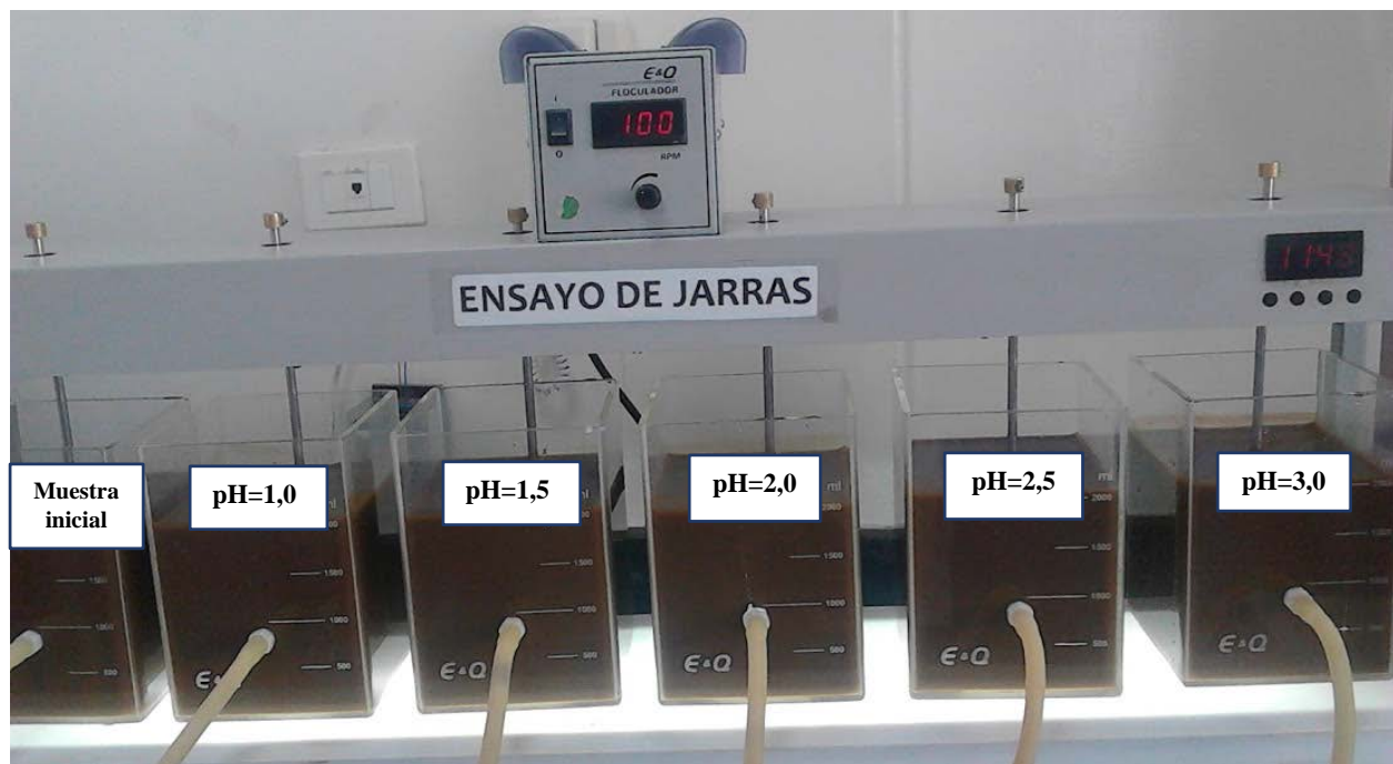
Figura 23. Ensayos de tratabilidad para la recuperación de sulfato de aluminio
