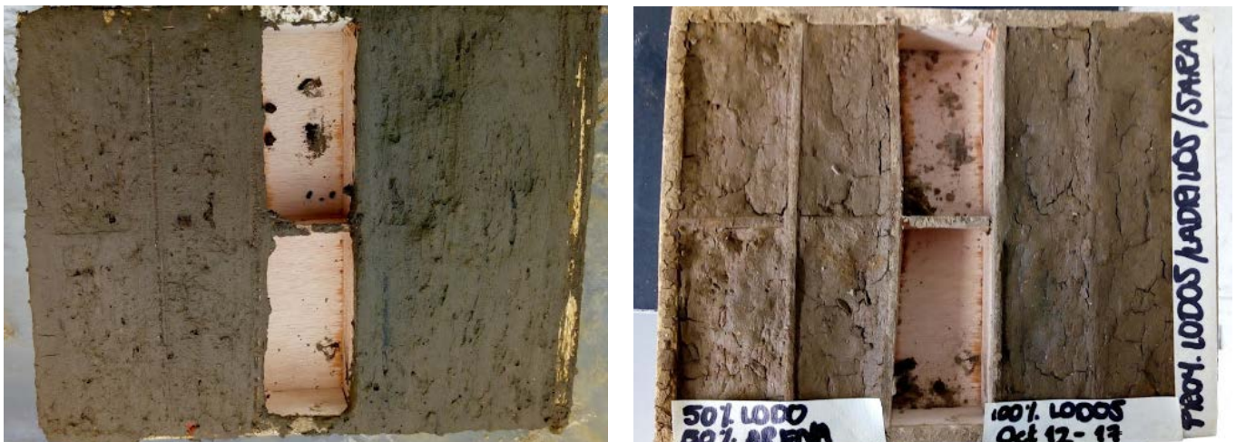
Figura 32. Moldeo de ladrillos de arena y lodo
