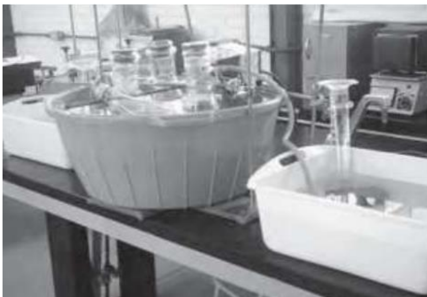
Figura 2. Biodigestor a escala de laboratorio con matraces.
