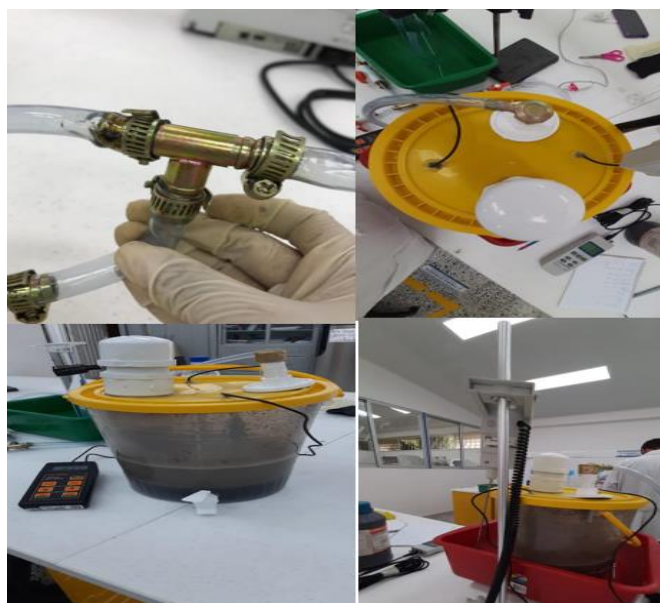
Figura 10. Montaje de tratamiento PLT1, prototipo de biodigestor en laboratorio
