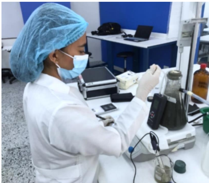
Figura 16. Montaje para la medición de concentración de gases usando un medidor multiparamétrico
