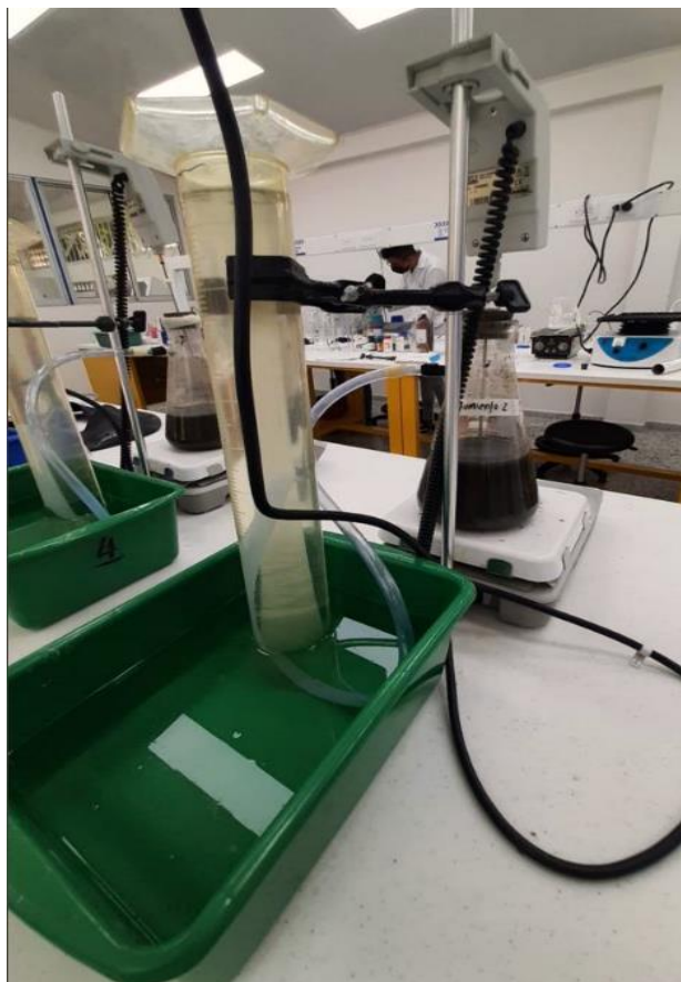
Figura 13. Montaje para producción de biogás, utilizando el método de desplazamiento de agua en probeta.
