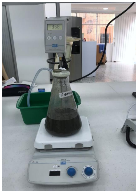
Figura 14. Montaje de tratamiento PLT2 y PLT3 en planchas de agitación para homogenizar las muestras.
