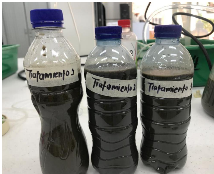
Figura 15. Muestra de biol (200ml) recolectada en cada prototipo de biodigestor
