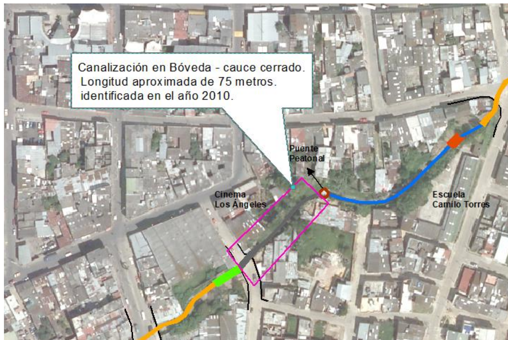
Imagen. 16 Canalización en Bóveda subterránea al cauce de la Quebrada La Parroquia. Año 2010.
