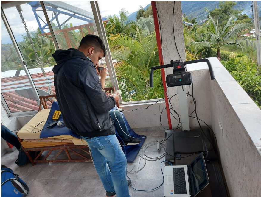
Figura 4: Inspección física y mantenimiento de la antena y conexiones
