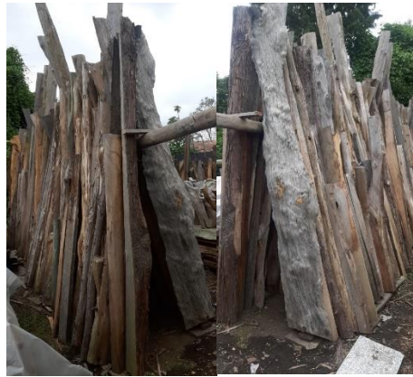
Figura 31 Secado de apilado en talanqueras y caballetes
