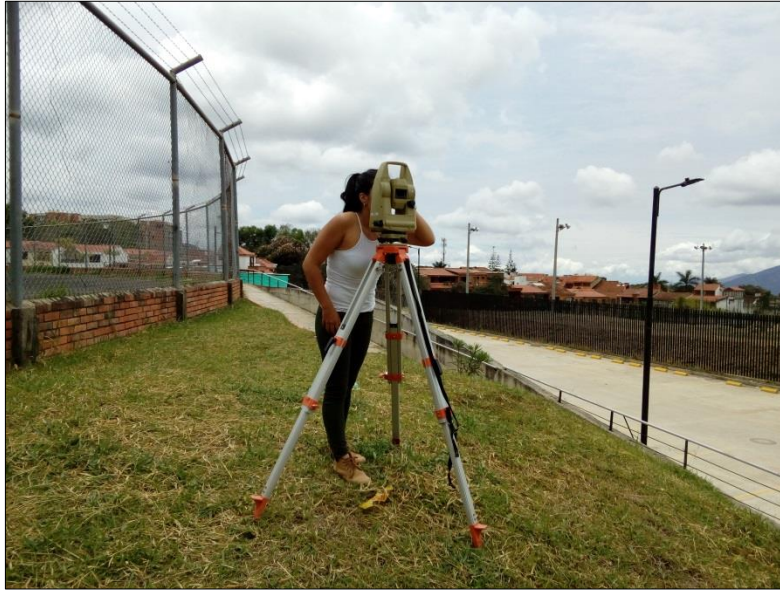
Fotografía 2 Toma de detalles con estación total. Fuente: Propia
