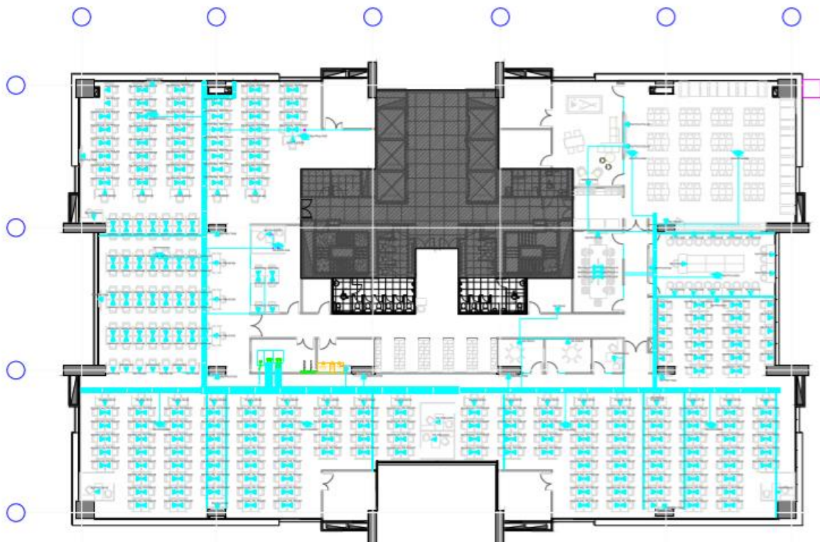
Figura 21. Planos en formato PDF cableado estructurado
