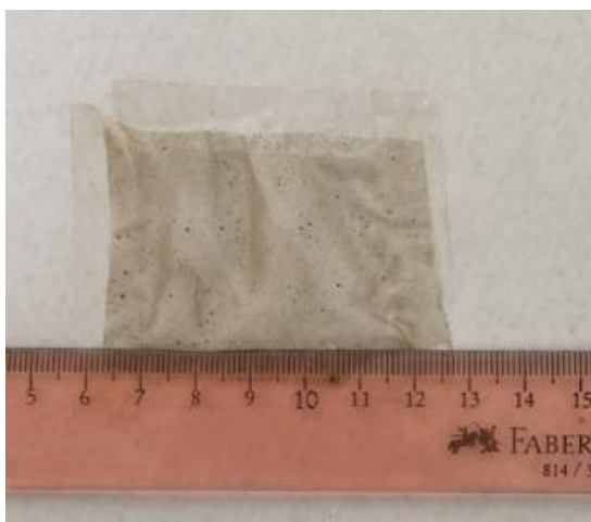
Figura 7. Replica de bioplástico con relleno de microalga.
