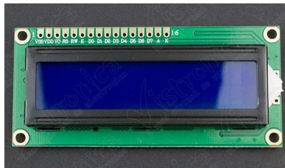
Figura 33 LCD 16x2 Backlight Azul Fuente: Vistronica
