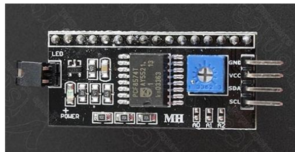
Figura 32 Placa I2C adaptadora LCD1602 Fuente: Vistronica
