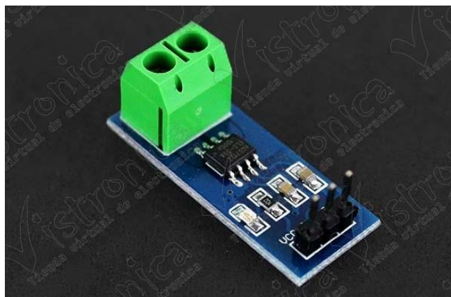
Figura 27 Modulo sensor de corriente ACS712 Fuente: Vistronica
