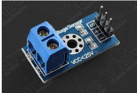
Figura 26 Modulo sensor de voltaje Fuente: Vistronica
