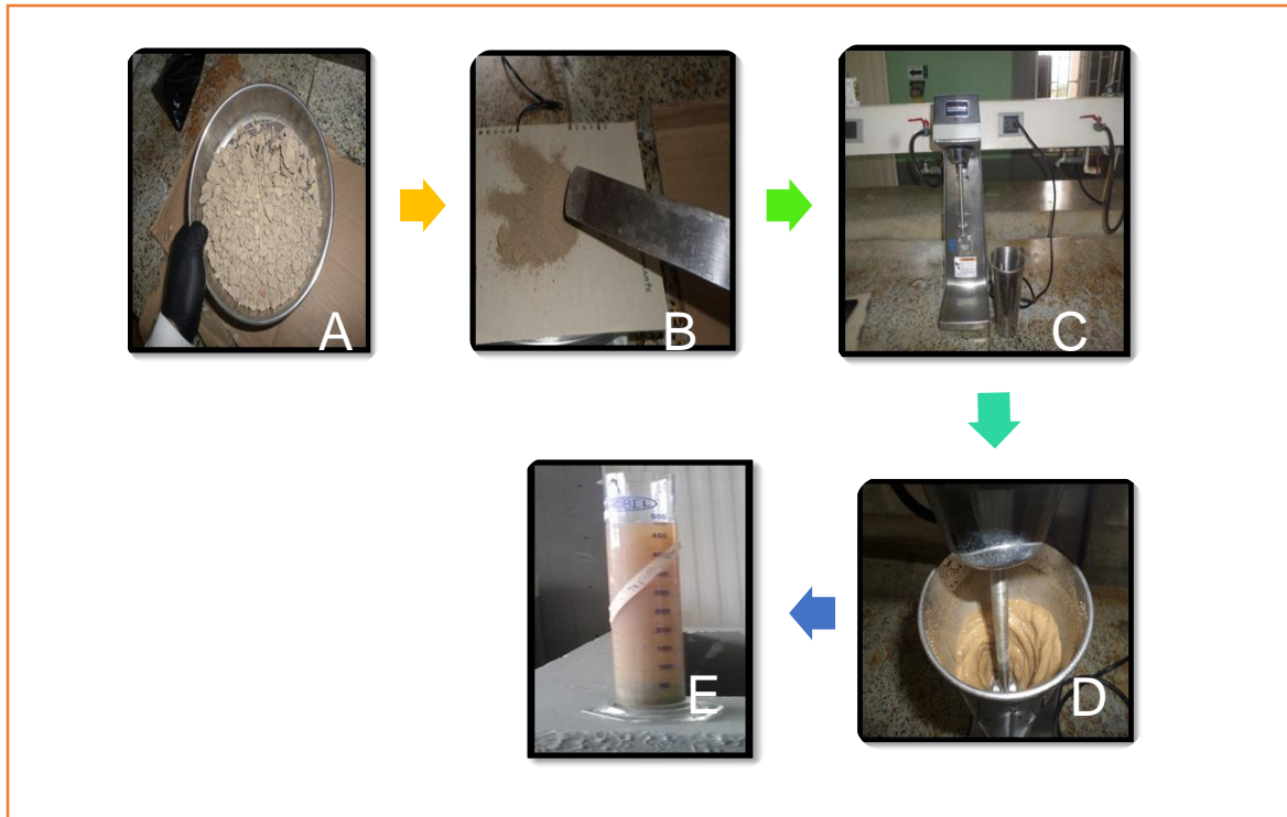
Figura 23. Prueba de laboratorio para determinar textura. Fuente: (Castro & Guevara, 2017).
