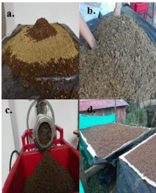
Figura 5: proceso de pelletizado, a. mezcla de las materias primas , b. homogenización , c. Pelletizado artesanal , d. secado a temperatura ambiente .
