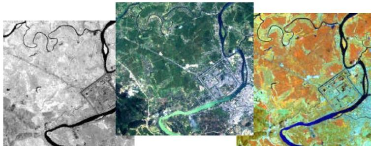
Ilustración 3. Resolución Espectral. Derecha: Imagen con una sola banda. Centro e izquierda: Combinación de tres bandas 3,2,1 y 4,5,3.
