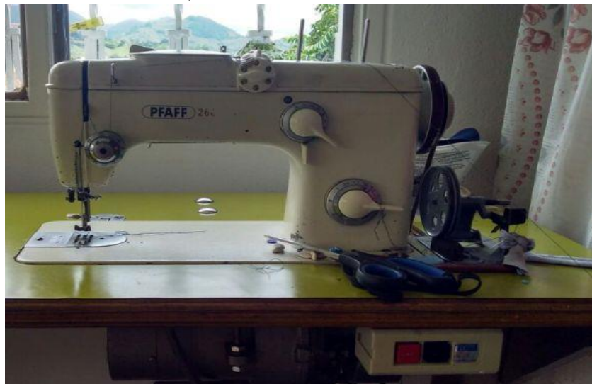
Ilustración 8 MAQUINA PLANA REF:260 MARCA PFAFF
