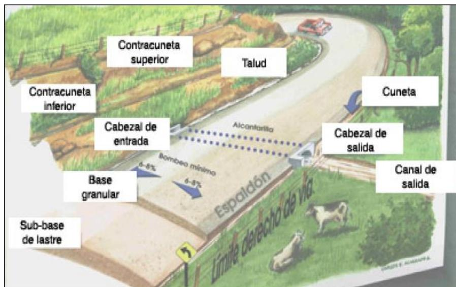
Imagen 1 Sistemas de drenaje y partes de la infraestructura vial. Fuente: (COSTA RICA. PROYECTO MOPT-GTZ)
