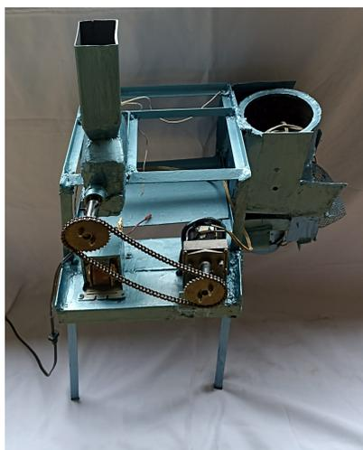
Figura 37. Motorreductor .
