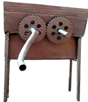
Figura 43. Triturador vista palanca de accionamiento .
