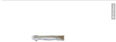
Figura 51. Producto extruido sin control de temperatura
