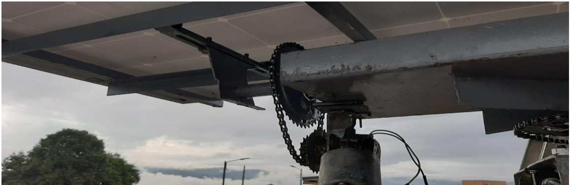
Figura 33. Implementación motores dc con transmisión de cadena.
