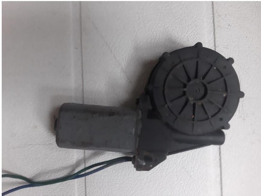
Figura 29. Motor DC 12v.
