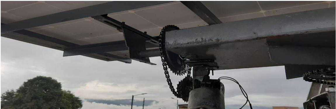
Figura 33. Implementación motores dc con transmisión de cadena.
