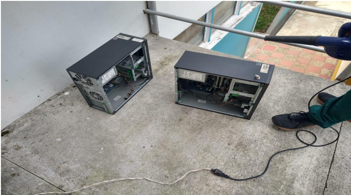
Figura 23. CPU en mantenimiento
