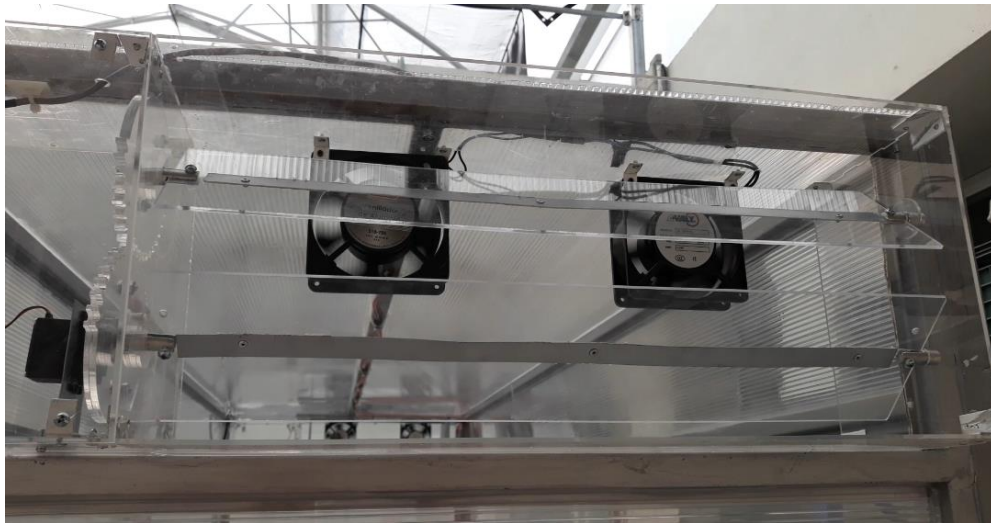
Figura 7.2 ventilas abiertas por el exceso de humedad o temperatura.
