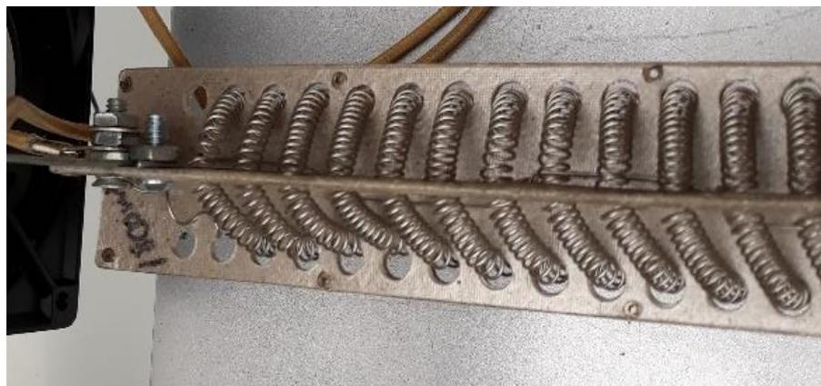
**Figura. 6.8 Resistencia Calefactora.**
