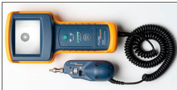
Figura 26. Equipo de verificación de conexiones de fibra óptica
