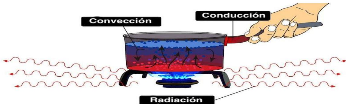
Figura 6. Descripción de fenómenos de transferencia de calor (Raffino, 2020)
