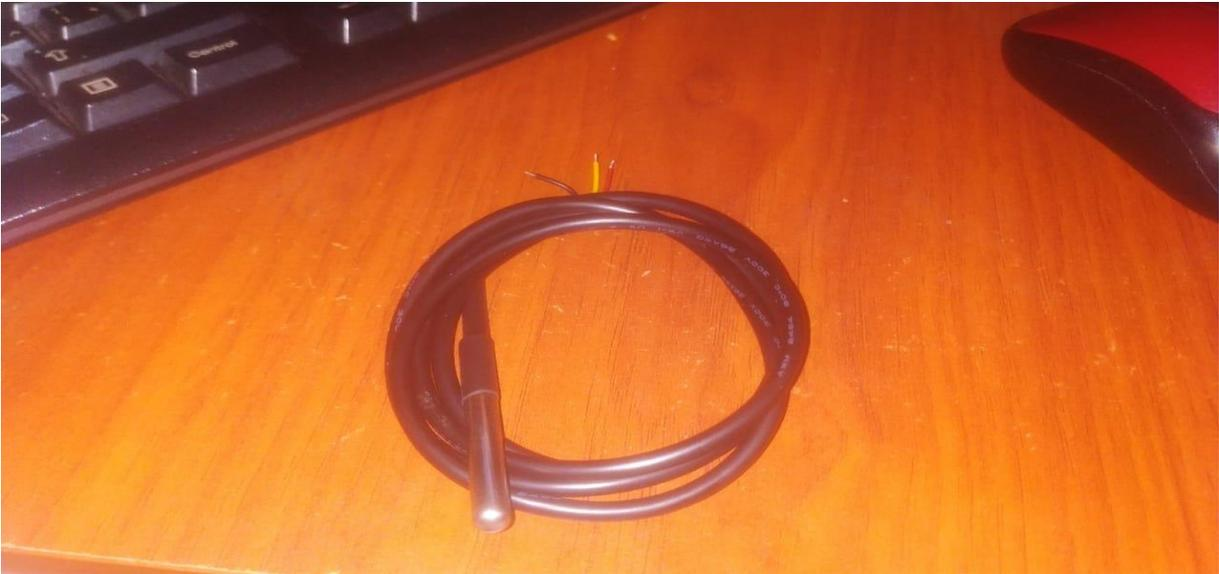
Figura 16. Sensor temperatura a prueba de agua ds18b20 (Negro (GND), Amarillo (DATA) Rojo (VCC)) fuente propia.
