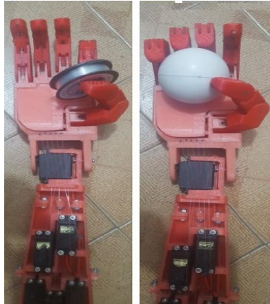
Figura 15. Prototipo de mano robótica de la Universidad Distrital Francisco José de Caldas.
