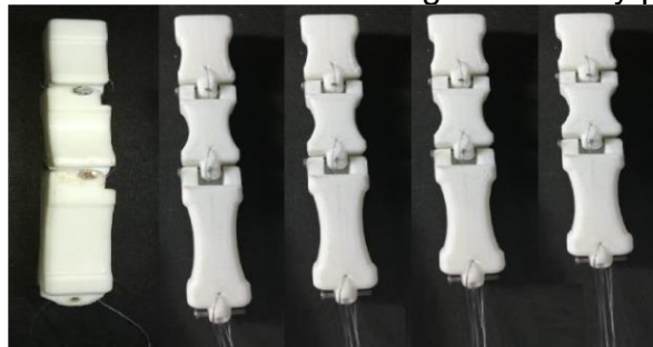
Figura 37. Ensamble entre las falanges medias y proximales.
