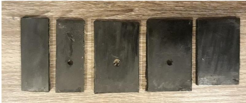
Figura 36. Laterales plasticos para construcción de celda.
