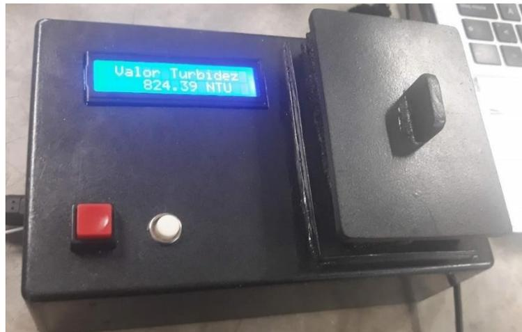
Figura 41. Resultado final de turbidímetro.
