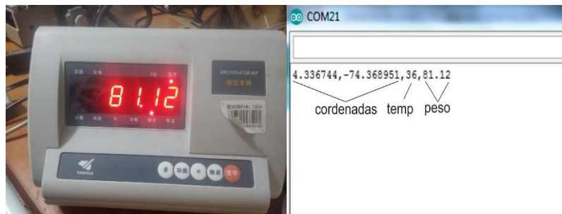
Figura 57. Registro de peso sobre la báscula y empaquetado de información para ser enviado
