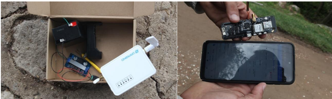
Figura 59. GateWay y nodo en pruebas de distancia de comunicacion
