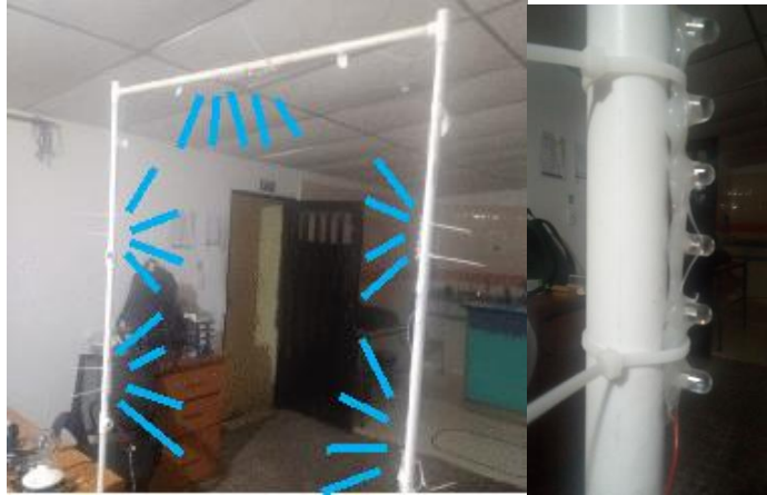
Figura 46. Arco con tiras de led infrarrojos emisores
