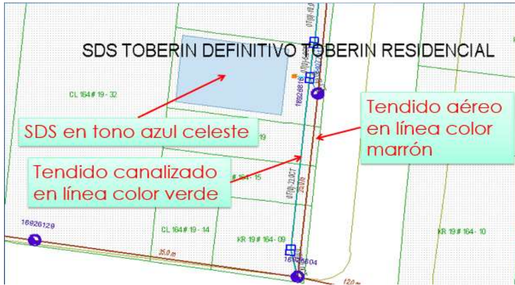
Figura 19 Nomenclatura utilizada en tendidos de F.O.
