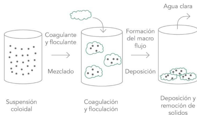
Figura 3. Esquema de coagulación y floculación de una suspensión coloidal (Nieto y Orellana, 2011)
