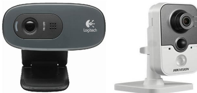
Figura 19. Cámara web y cámara Ip
