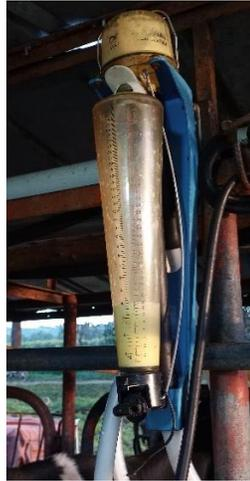
*Nota.* Este medidor retiene en una cámara calibrada una cantidad proporcional de la leche ordeñada, a partir de la cual se puede conocer la cantidad total producida por una vaca o se puede retirar de la cámara para ser pesada. Fuente: Imagen propia.
