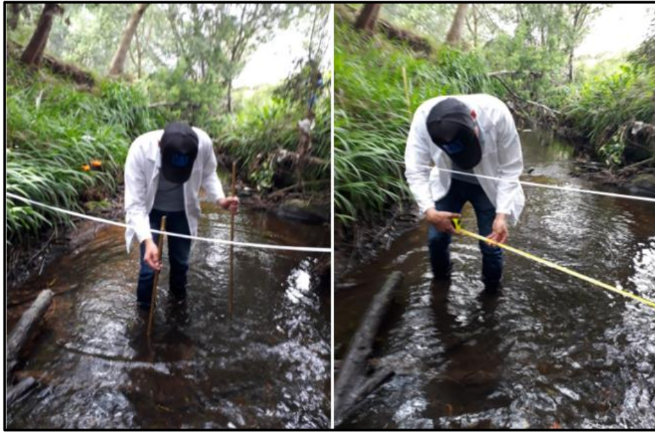
Figura 15: Levantamiento de las secciones transversales.
