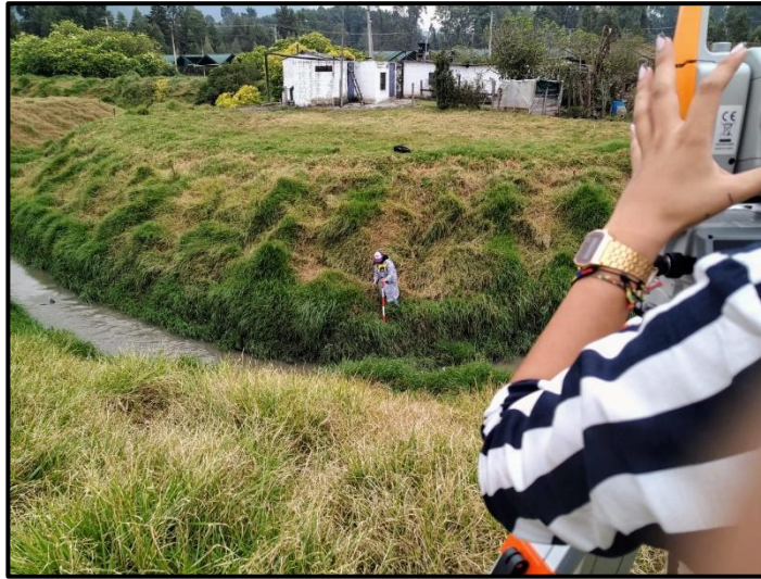
Figura 11: Levantamiento de secciones transversales y cotas mediante GPS, Estación total y prisma para la altimetría.
