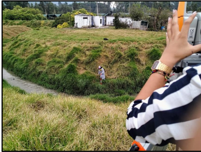
Figura 11: Levantamiento de secciones transversales y cotas mediante GPS, Estación total y prisma para la altimetría.
