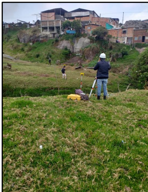
Figura 10: Levantamiento de secciones transversales y cotas mediante GPS, Estación total y prisma para la altimetría.
