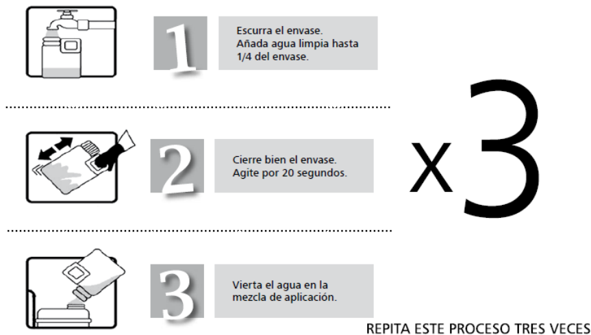
Ilustración 36 Proceso de triple lavado fuente: Guías de buenas prácticas ambientales para cultivo de flores y ornamentales. 2010
