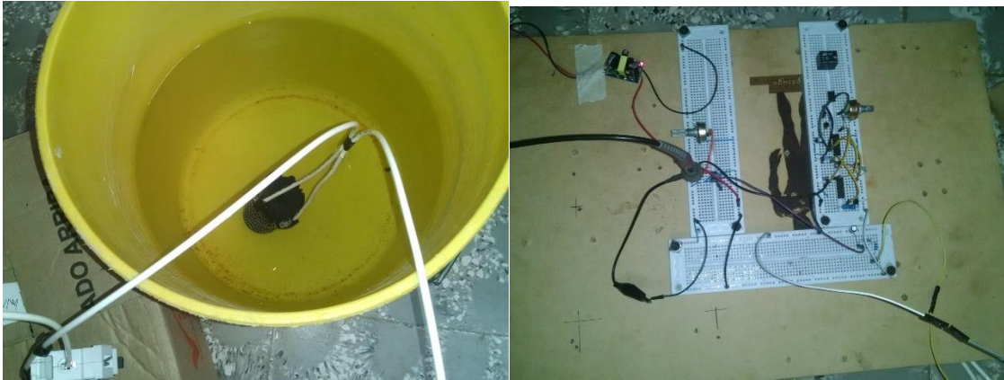
Ilustración 33: Prueba carga inductiva de 27A. Autor
