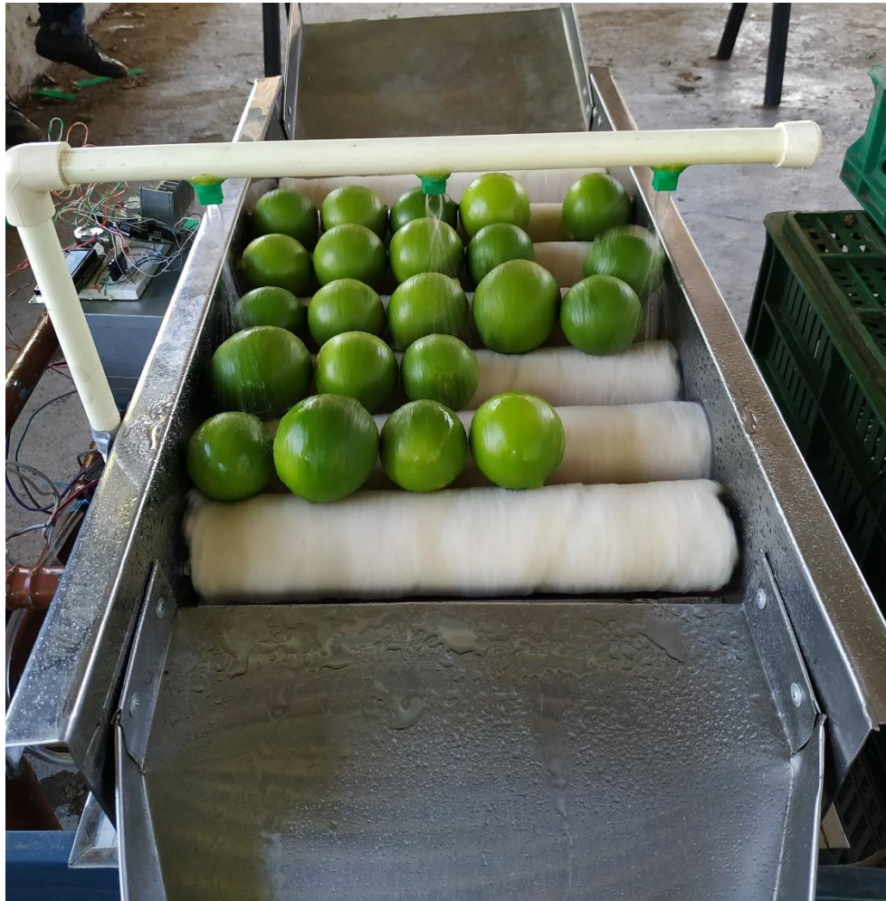
Figura 76. Funcionamiento etapa de encerado del limón
