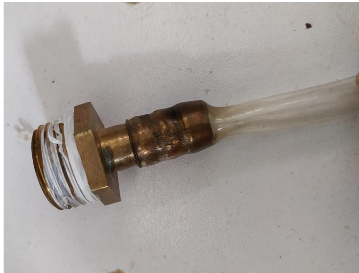
Figura 71. Adaptador ubicado en la entrada de la válvula
