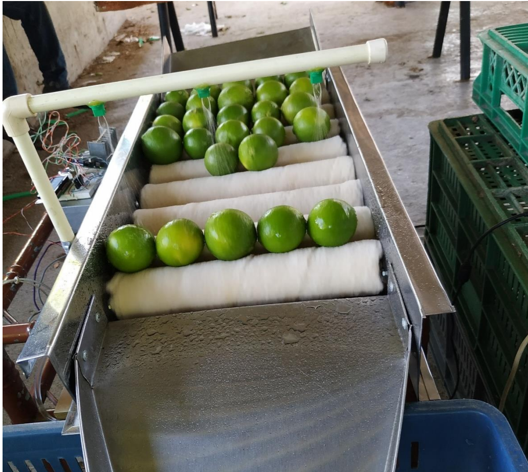
Figura 77. Se activa el sistema de aspersión 30 segundos después de haber detectado que el limón pasa por el sensor.
