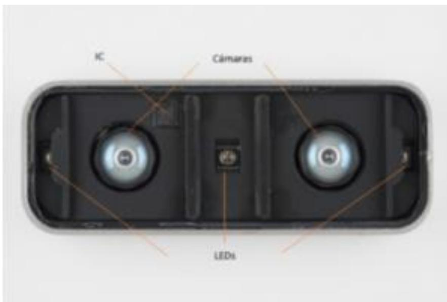
Como se puede observar, el sensor cuenta con tres LEDs, dos cámaras y un microcontrolador.
