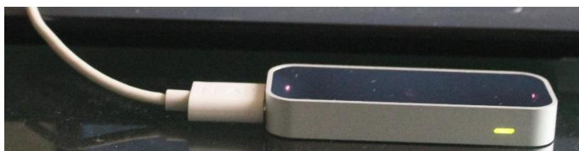
Una vez probado el sensor de manera horizontal, se procede a colocarlo de manera vertical, con la luz verde hacia la superficie de la mesa –y a la misma altura de la prueba anterior-; si bien el sensor capta las manos, no las reconoce correctamente –es decir, se toma la derecha como si fuera la izquierda-, de igual manera, pasado cierto tiempo deja de reconocerlas.
