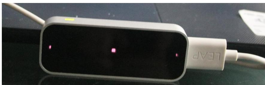
Luego de realizar las pruebas con el sensor en diversas posiciones, se concluyó que lo adecuado es trabajar con el mismo de manera horizontal y con el LED verde hacia el usuario final.
