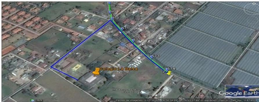
**Figura N°7:** Ruta de Fibra Óptica para el Colegio La Balsa.
